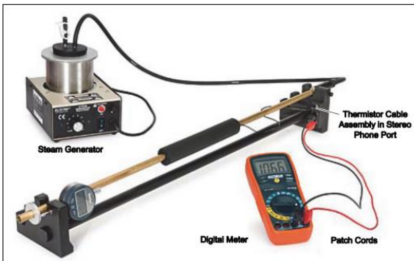
Figura (1): Conexión del termistor
