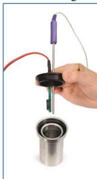
Figura (1) Colocación de la Sonda de Temperatura en el Calorímetro junto con la Resistencia
