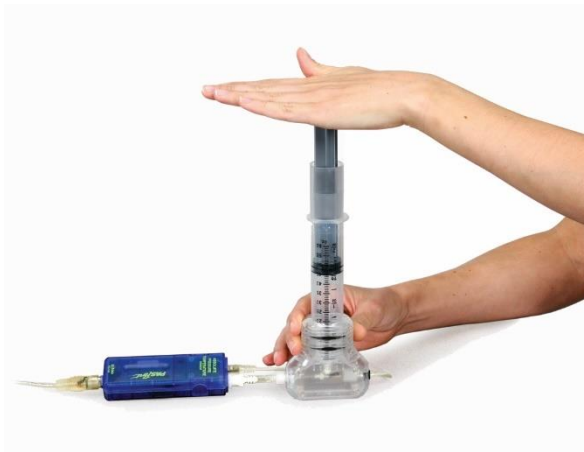
Figura (2): Forma de presiona el Aparato de gases ideales
