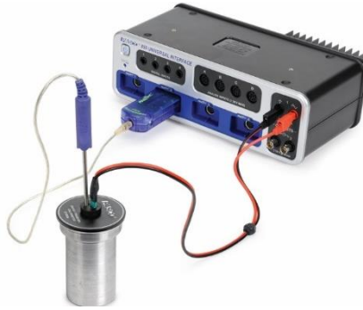
Figura (2) Arreglo del Sensor de Temperatura y La resistencia Conectada con la Interfaz
