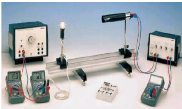
Figura1: Configuración Experimental para la comprobación de la ley de Stefan – Boltzmann
