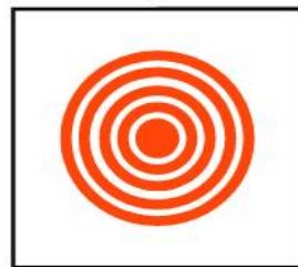
Figura de interferencia con los espejos M_1 y M_2 perpendiculares
